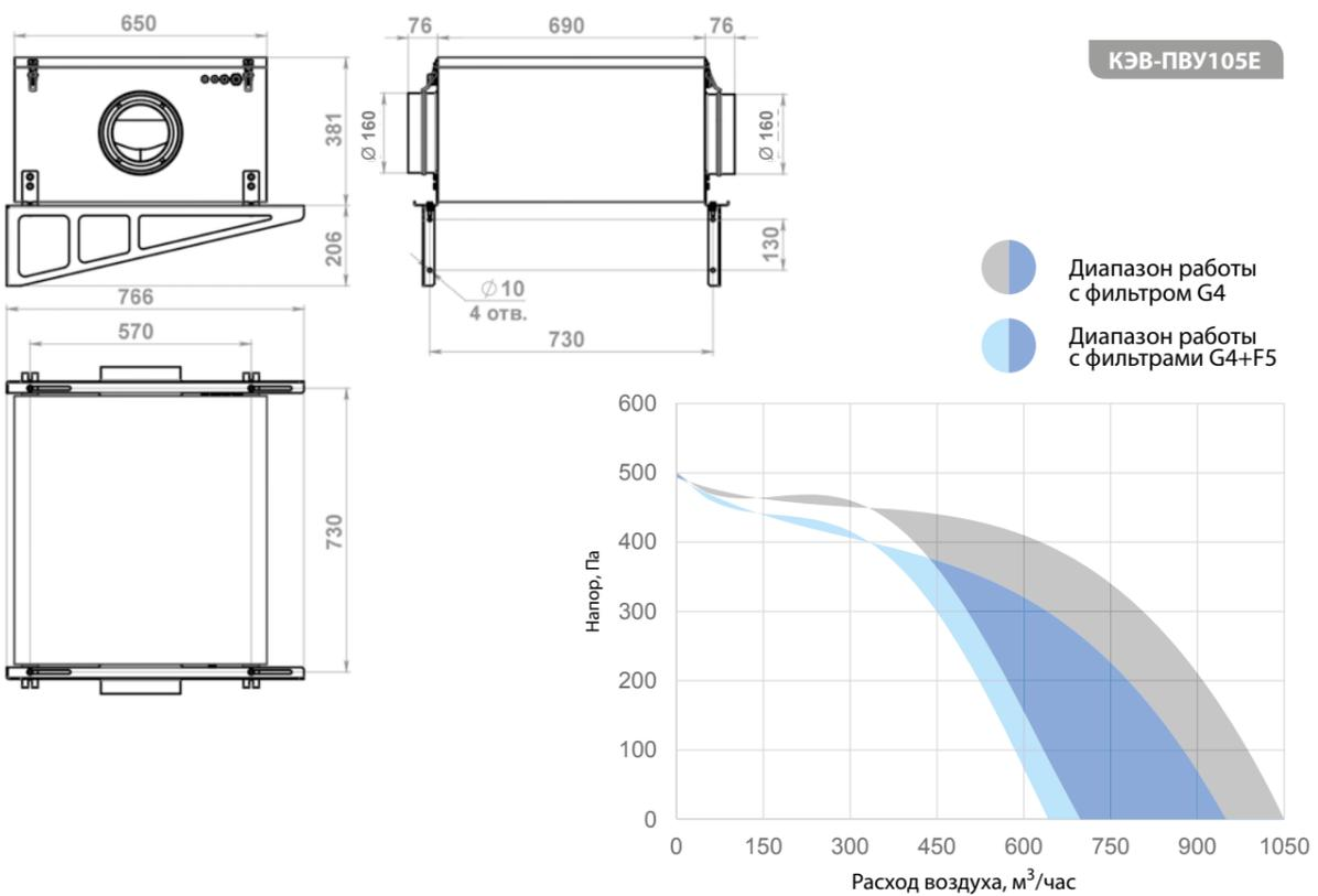
Компактные вентиляционные установки
