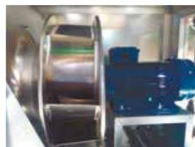
Секция вентилятора с АС-двигателем
