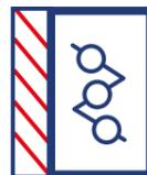
Гибкие вставки предназначены для предотвращения передачи вибрации воздуховодам от вентиляционных установок. Гибкие вставки изготавливаются в различном исполнении и имеют присоединительные фланцы.
