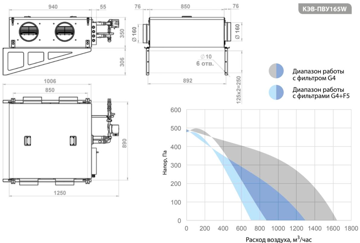
Компактные вентиляционные установки
